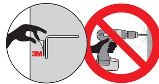
Fissaggio a muro e vetro ottenuto con uno speciale nastro biadesivo in schiuma acrilica ad alte prestazioni (3M™ VHB™).
