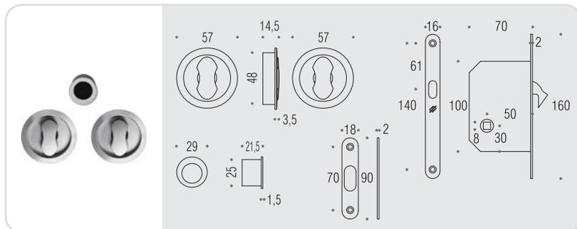
Kit per porta scorrevole composto da due maniglie ad incasso con dispositivo di chiusura a nottolino, maniglia di trascinamento e serratura (E 50mm) a gancio dotata di contropiastra in acciaio inox.
