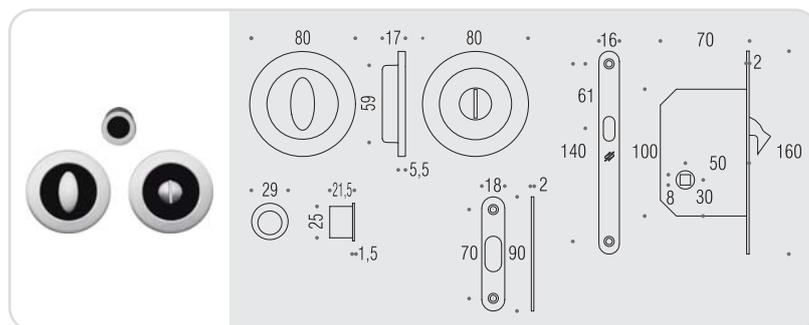
Kit per porta scorrevole composto da due maniglie ad incasso con dispositivo di chiusura a nottolino, maniglietta di trascinamento e serratura (E 50mm) a gancio dotata di contropiastra in acciaio inox.
