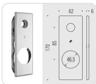
Placca quadrata int. 85mm con sottoplacca in nylon compresa di 5 viti di fissaggio (utilizzabile solo con inserti PB06 e PB07)
