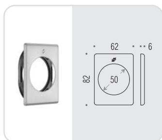
Rosetta quadrata con sottorosetta in nylon per defeder  $\varnothing$ 50mm compresa di 5 viti di fissaggio.
