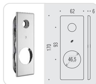
Placca quadrata int. 93mm con sottoplacca in nylon compresa di 5 viti di fissaggio (utilizzabile solo con inserti PB05 e PB08)
