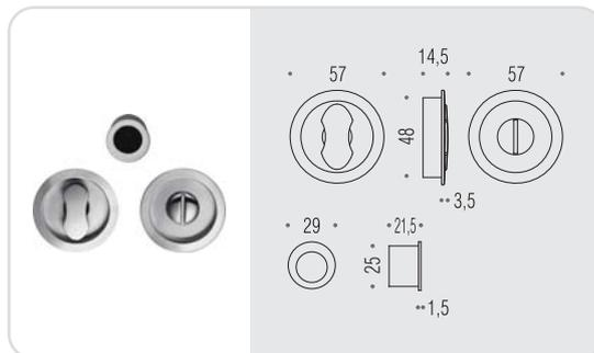
Kit per porta scorrevole composto da due maniglie ad incasso con dispositivo di chiusura a nottolino e maniglia di trascinamento (senza serratura).
