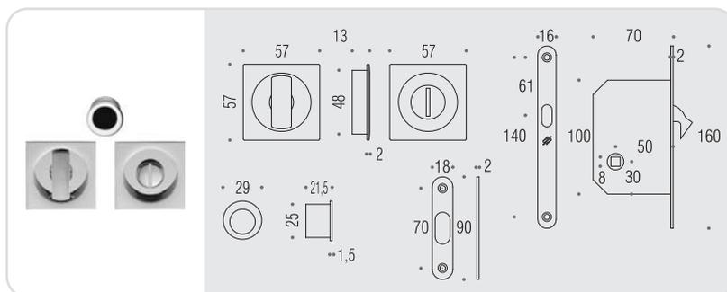
Kit per porta scorrevole composto da due maniglie ad incasso con dispositivo di chiusura a nottolino, maniglia di trascimento e serratura (E 50mm) a gancio dotata di contropiastra in acciaio inox.
