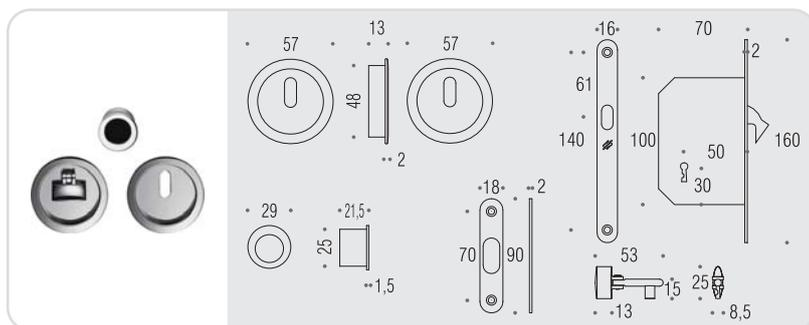
Kit per porta scorrevole composto da due maniglie ad incasso con dispositivo di chiusura con chiave, maniglia di trascinamento e serratura (E 50mm) a gancio dotata di contropiastra in acciaio inox.
