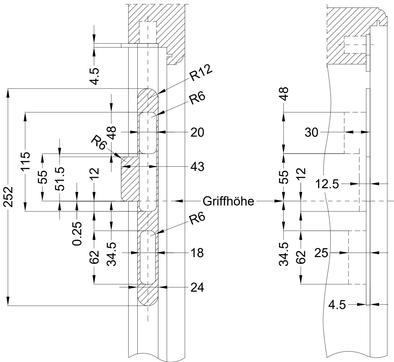
**Einbausituationen der Bauteile mit Fräsmäßen**
